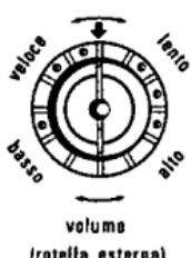
Le rotelle di regolazione del ritmo tonale e del volume si trovano sulla parte destra dell'apparecchio. Richiedete una chiamata e, mentre la soneria squilla, senza sollevare il ricevitore, procedete alla regolazione.
